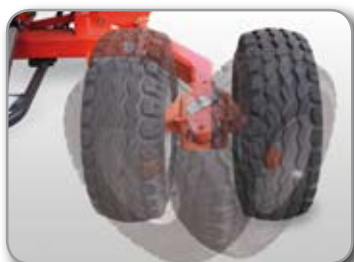
Under vejtransport kan højre hjul drejes indad
