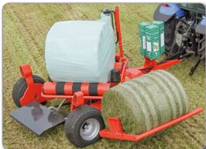
Læsning under indpakningen øger effektiviteten.
