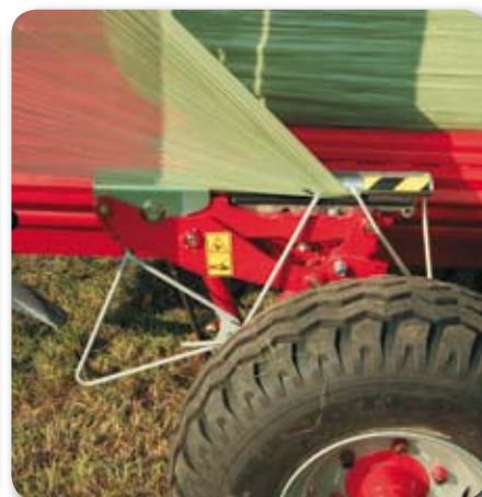
Efter indpakningen skæres filmen over med to filmskærere af "saksetypen". Filmen fastholdes sikkert under af- og pålæsning af ballerne.
