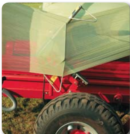
Efter indpakningen skæres filmen over med to filmskærere af "saksetypen". Filmen fastholdes sikkert under af- og pålæsning af ballerne.
