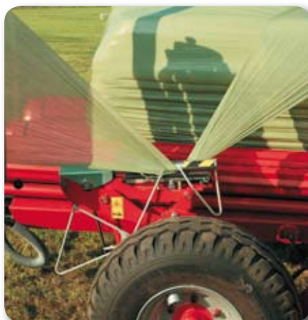
Efter indpakningen skæres filmen over med to filmskærere af "saksetypen". Filmen fastholdes sikkert under af- og pålæsning af ballerne.
