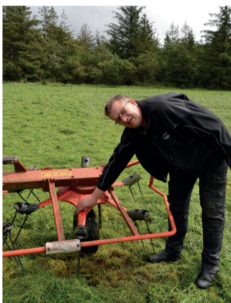
Kris Stokholm fremhæver især konstruktionskvaliteten hos sin KUHN vender. – Konstruktionen med en kraftig bukket plade, kraftige aksler og en lille diameter virker særdeles robust. Maskinen er nem at indstille fra traktoren, siger han.
