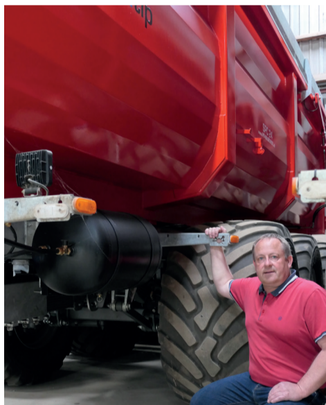
Fremover forventer Jens Henrik Andersen, at luftbremser bliver det system, der anvendes. MI Tip SPC 24 vognene kan leveres både med og uden samt i en kombi-version med både hydrauliske og luftbremser.
