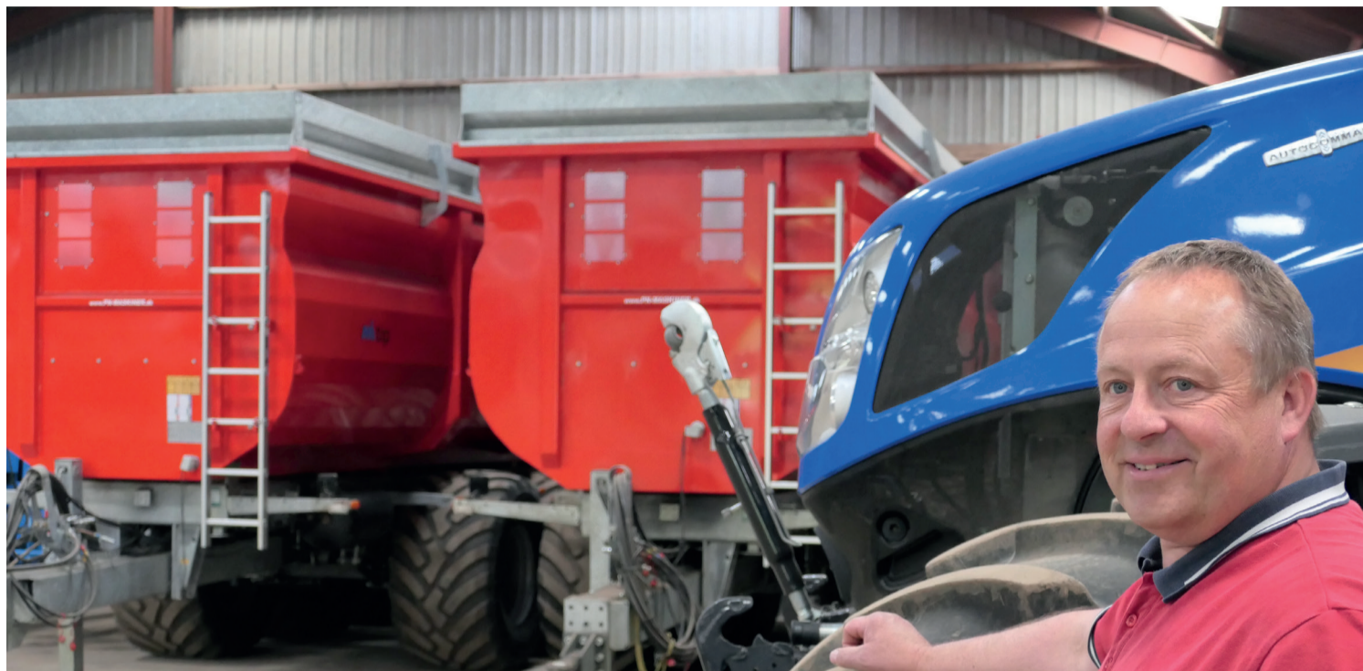
Med drejbare forreste og bageste aksel kan Jens Henrik Andersen, Enghavegaard Aps nær Bogense, svinge rundt på cementpladsen med sine treakslede MI-vogne uden af lave sorte streger. - Jeg forventer, dæk og hjul holder længere med det system, siger han.
