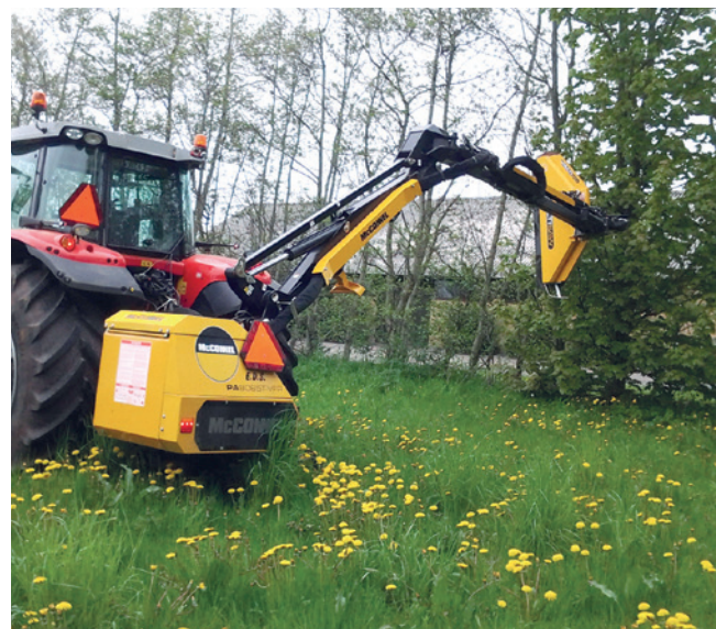
Klippearbejdet foregår lige ud for førerhuset, så chaufføren skal ikke dreje sig bagud for at følge med.
