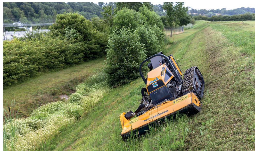
Hældningen er tæt på 60 grader, men det er ingen hindring for RobotCut. Allan Clausen styrer den via fjernbetjening på sikker afstand.
