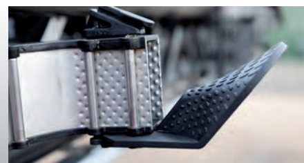
Spredplader kan monteres i 2 positioner
