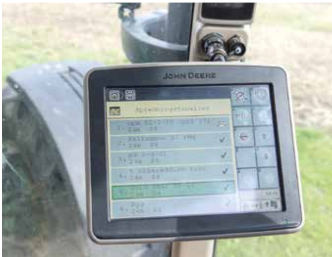
Johan Ziskas John Deere traktor har RTK-autostyring og er ISOBUS-kompatibel, hvilket kan udnyttes fuldt ud på Rauch Axis gødningsspreaderen.
