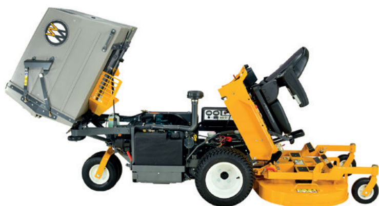
2-delt chassis for nem og hurtig service og rengøring.
