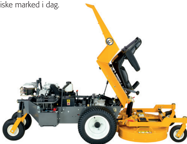
2-delt chassis for nem og hurtig service og rengøring.
