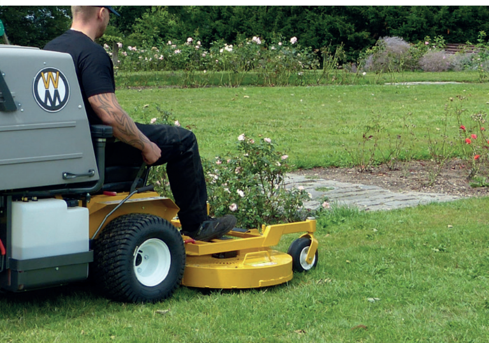
Tilt-up af klippebord til 90 grader uden brug af værktøj gør det nemt at udføre rengøring og service.
