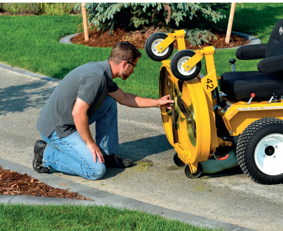
Tilt-up af klipperbord til 90 grader uden brug af værktøj, gør det nemt at udføre rengøring og service.
