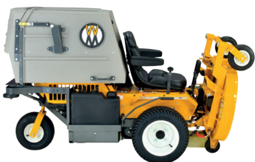
Tilt-up af klipperbord til 90 grader uden brug af værktøj, gør det nemt at udføre rengøring og service.
