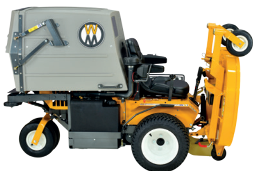
Tilt-up af klippebord til 90 grader uden brug af værktøj gør det nemt at udføre rengøring og service.
