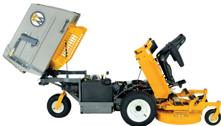
2-delt chassis for nem og hurtig service og rengøring.
