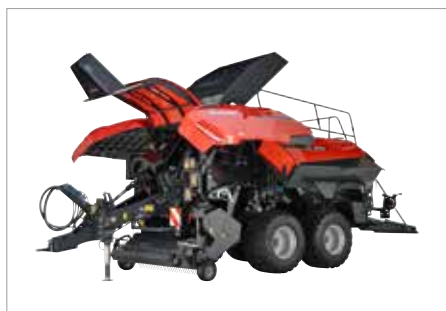
2. Svingbare garnkasser, som sikrer nem vedligeholdelse
