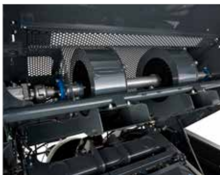
6. Blæsere til rengøring af bindeapparat
