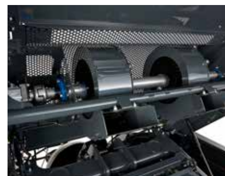
6. Blæsere til rengøring af bindeapparat
