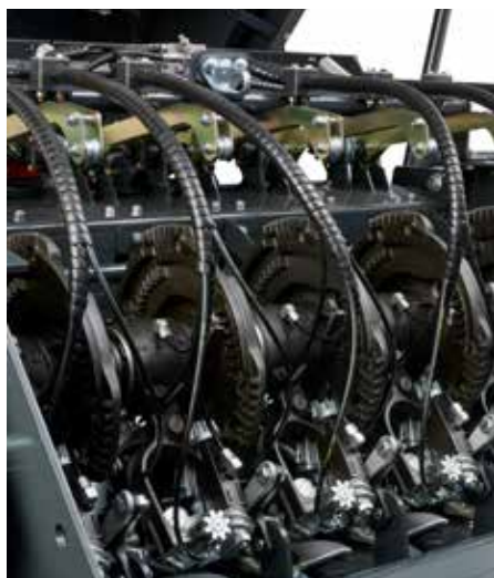
1. Dobbelt bindesystem med elektronisk overvågning som standard.
