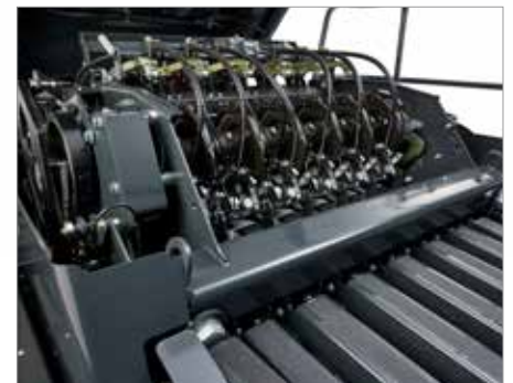
4. Dobbelt bindesystem med elektronisk overvågning som standard.
