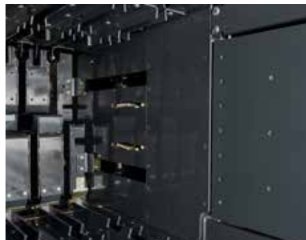
3. Udskiftelige, slidstærke komponenter i ballekanalen.
