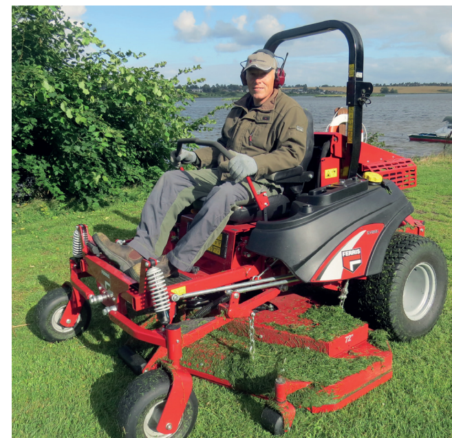
Sammenlignet med forgængerens er den nye græsklipper blandt andet forbedret med fodbetjent, hydraulisk løft af klippebordet, og køleren er større end på den gamle.
