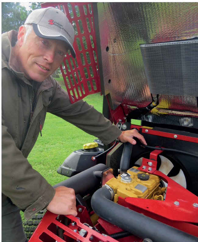
Henning Jensen har åbnet op til græsklipperens vandkølede Caterpillar dieselmotor på 33,5 hk. - Maskinen har rigeligt med motorkraft, også selv om bioklip-funktionen kræver ekstra motorkraft, siger han.
