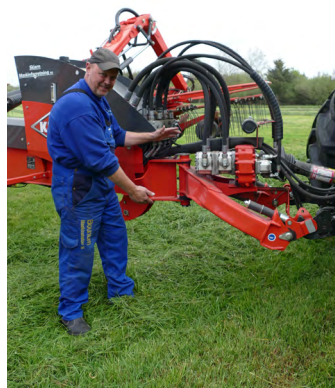
Maskinfører Jan Ravn fra Bounum Maskinstation viser her, hvordan svinghovedet er anbragt bag maskinens store hydraulikpumpe og derved skåner PTO-akslen.
