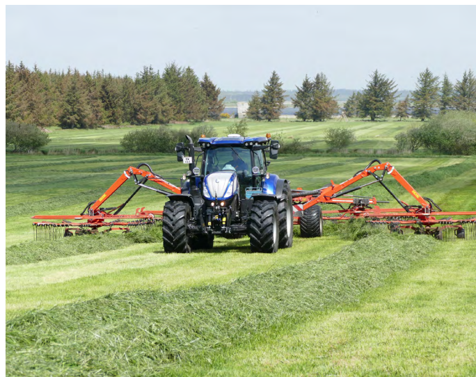
KUHN GA 15131 har fire rotorere, 13 rivearme på de forreste der kan boostes til 20% højere omdrejningshastigheder og 15 rivearme på de bagerste rotorere, der kan flytte en større mængde græs.
