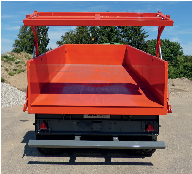
Vognkasserne er skabt i robust 4 mm Hardox stål og er hurtige at tømme for indhold med bagtip.
