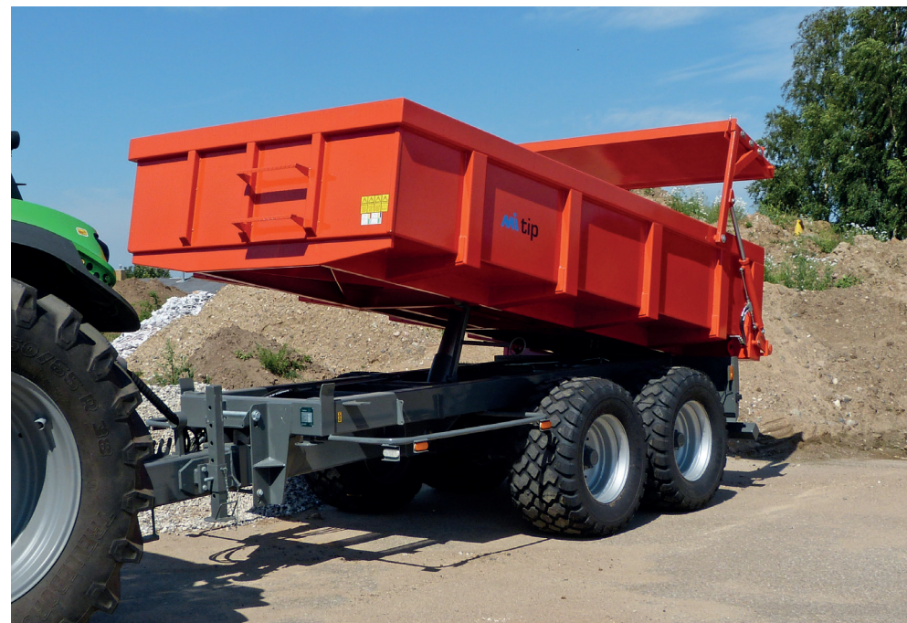
SPD entreprenørvognene kan laste 12 eller 16 tons. De har vippe bogie og affjedret træk for stabil kørsel, selv i ujævnt terræn.
